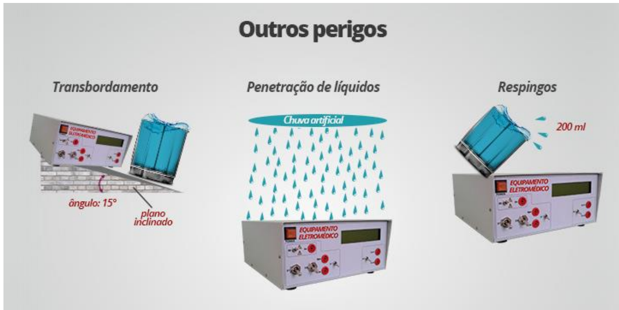
Outros perigos relacionados a líquidos, respingos e umidade. Fonte: elaborada pela Sociedade Brasileira de Metrologia (SBM).
