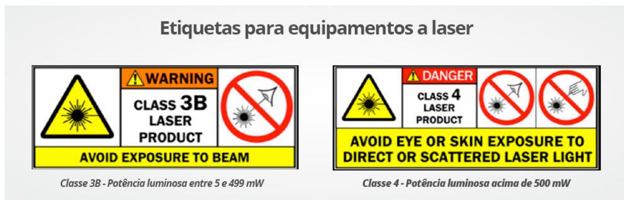
Figura 6. Etiquetas para equipamentos a laser das classes 3B e 4.
