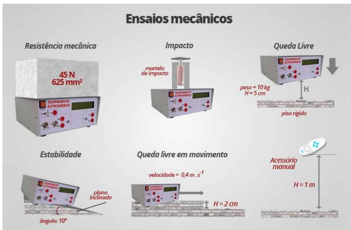
Figura 7. Ensaios para avaliar o perigo mecânico de equipamentos eletromédicos.
