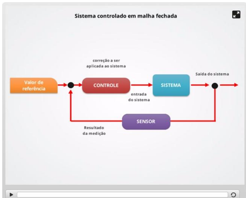
Figura 6. Sistema com controle em malha fechada.
