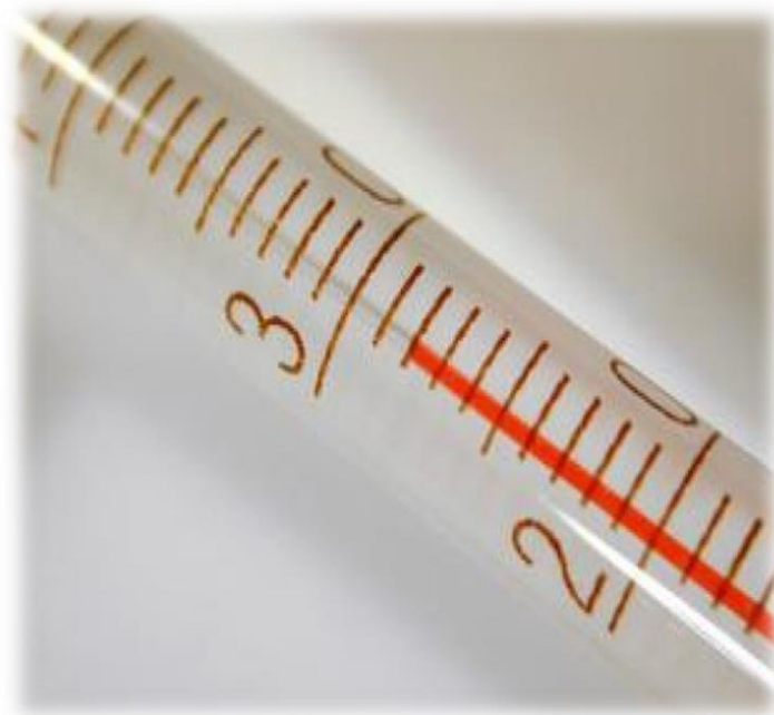
Termômetro de líquido em vidro com valor de uma divisão igual a 1 °C
