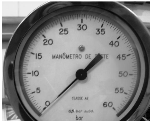
Figura 1: Manômetro analógico. Fonte: o autor
