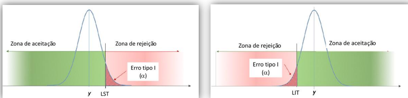
Figura 3 (adaptada do EUROLAB Technical Report No.1/2017): exemplo com tolerância única superior e inferior.
