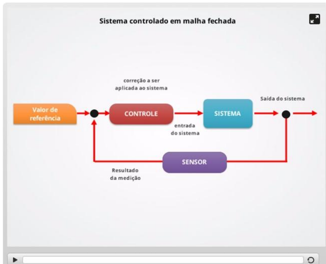
Figura 6. Sistema com controle em malha fechada.
