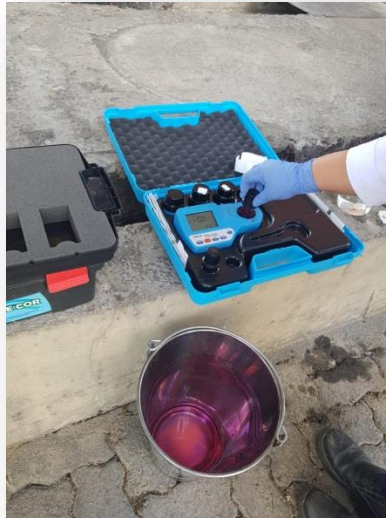
Ensaio subsequente de análise de cloro residual livre
