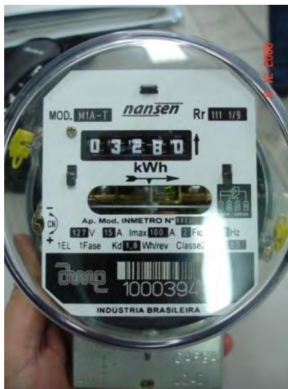
Medidor de energia elétrica
