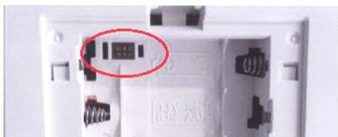
Figura 3 – Local indicado para colocação do conector “JIG” durante modo de ensaio
