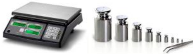
Figura 2 – Balança eletrônica (instrumento de medição indicador para medição de massa) e pesos-padrão (medidas materializadas)
