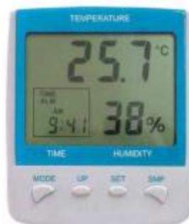
Figura 5 – Termo-higrômetro digital, com indicação de temperatura (resolução de 0,1 °C) e umidade relativa (resolução 1%)
