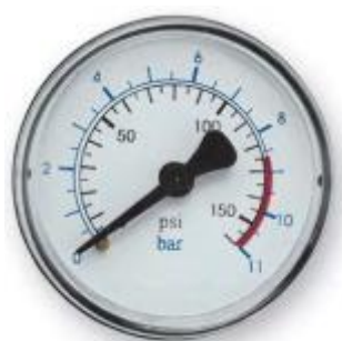
Figura 6 – Manômetro analógico (resolução de 0,25 bar e 2,5 psi)
