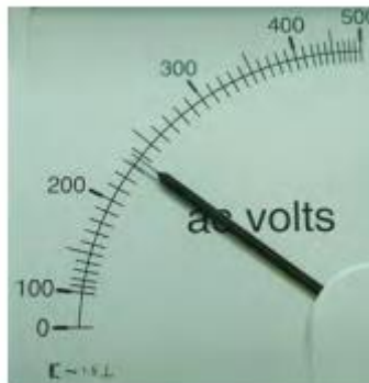
Figura 3 – Leitura de uma grandeza em um instrumento de medição analógico
