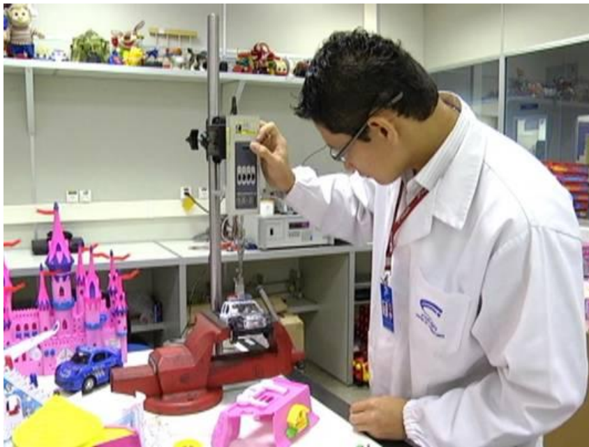
Ewerson Nascimento testa resistência de brinquedos
