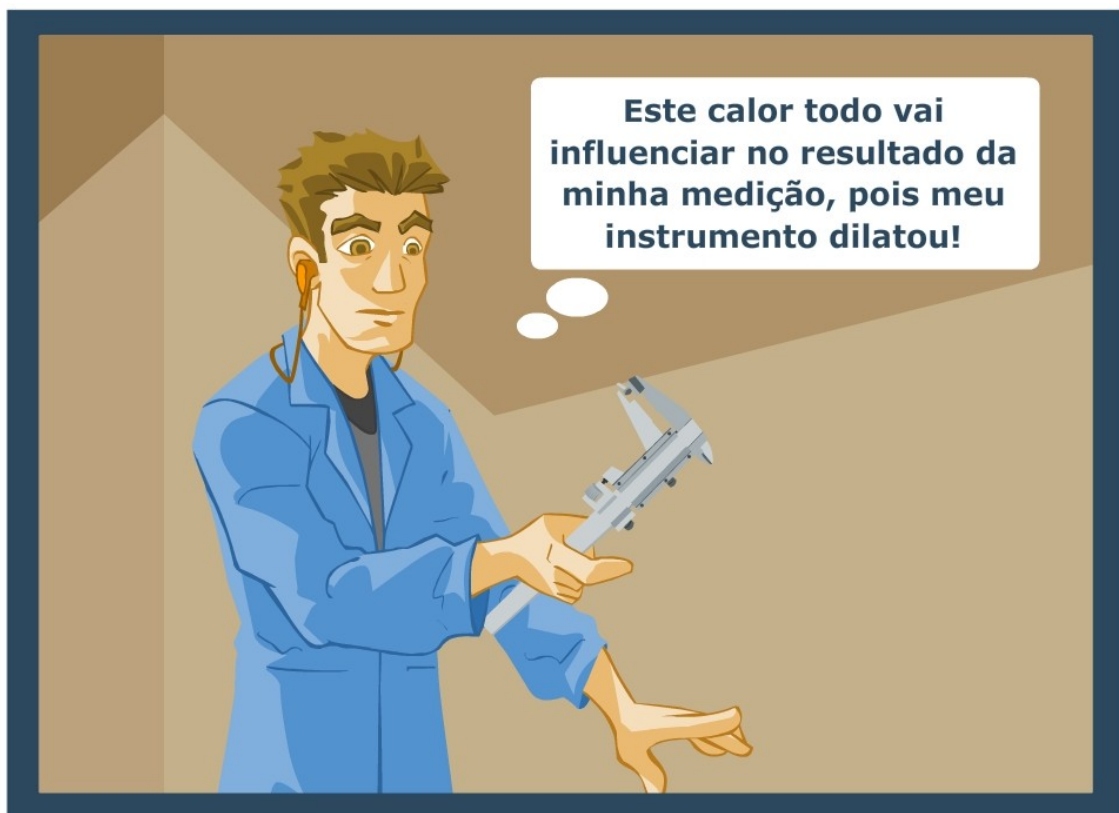
Figura 12: A temperatura do ambiente é um fator que pode influenciar no resultado da medição
