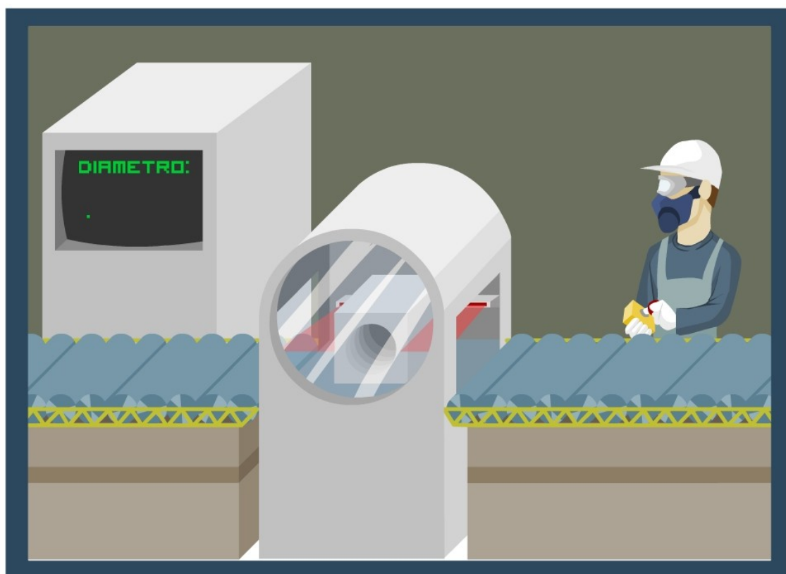
Figura 44: Medição do diâmetro de uma peça por um sistema de medição
