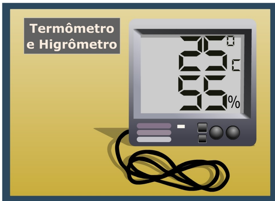
Figura 50: O higrômetro é um exemplo de instrumento de medição digital
