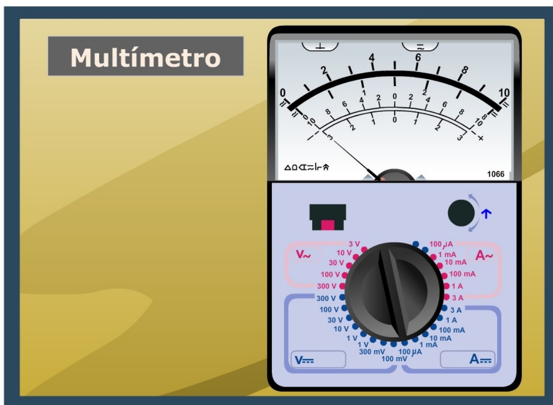
Figura 46: O multímetro é um exemplo de instrumento de medição analógico
