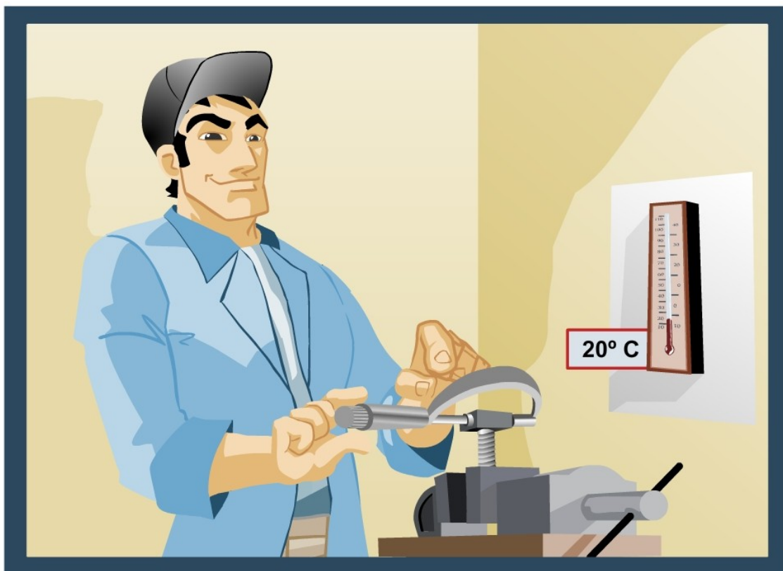
Figura 4: Caso em que a temperatura ambiente pode influenciar no resultado da medição
