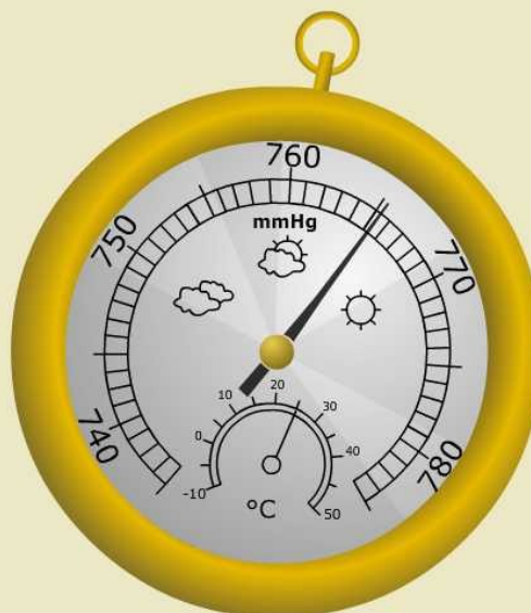
Figura 18: Barômetro aponta a pressão atmosférica
