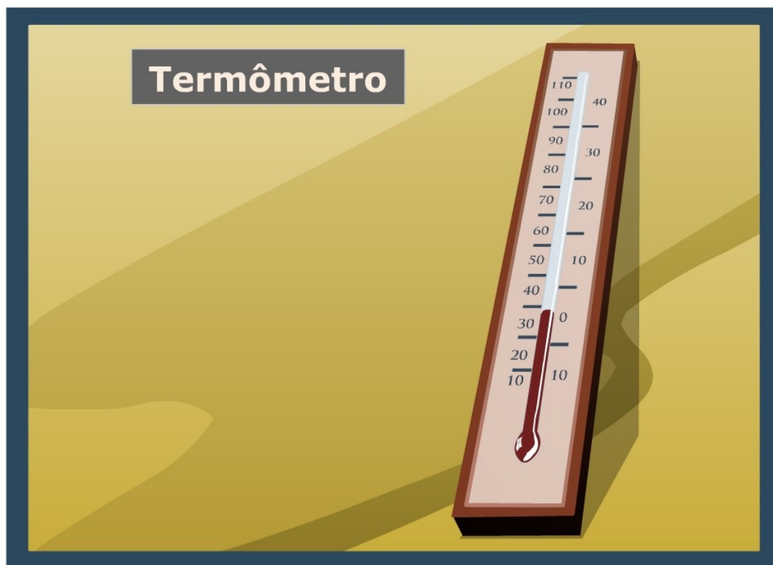
Figura 9: O termômetro é um exemplo de instrumento de medição analógico
