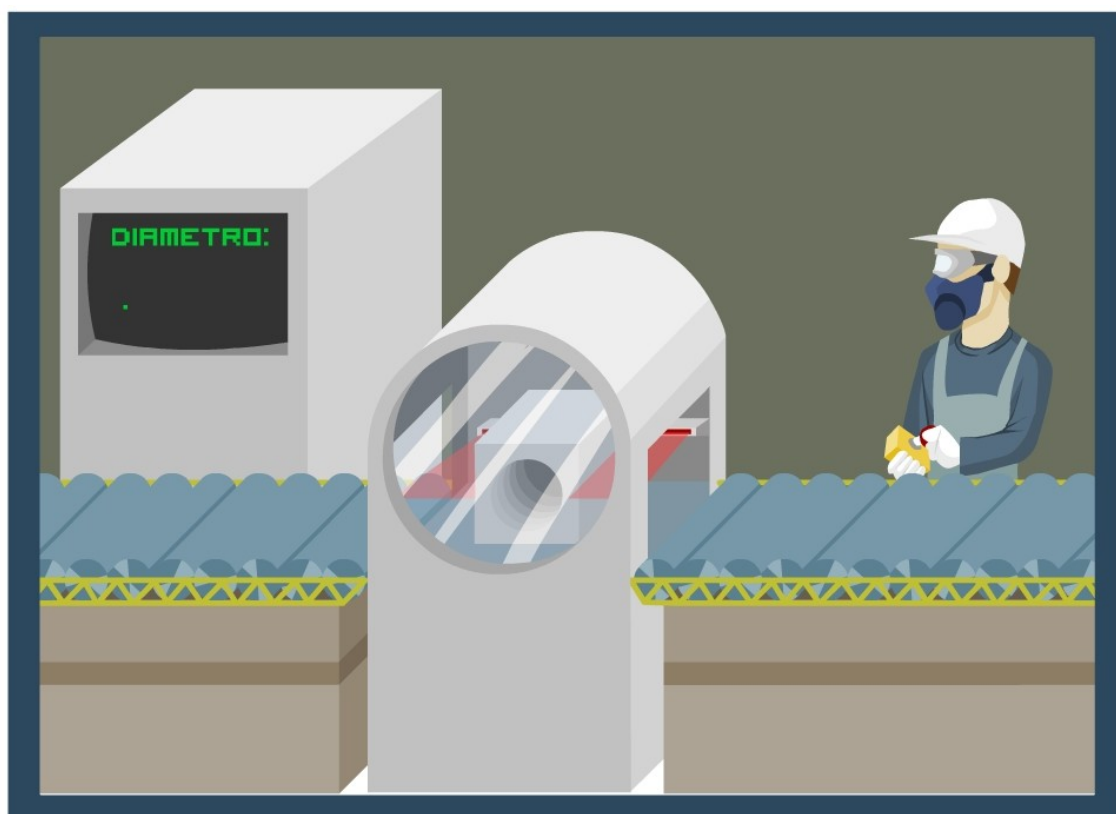
Figura 5: Medição do diâmetro de uma peça por um sistema de medição
